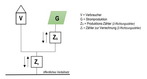
Beispiel 4 Messung nach Eigenverbrauchsprinzip - Stromerzeugungsanlage über 30 kVA → Parallel
